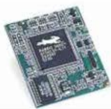
Fig. 1 Modulul RabbitCore 3400 (C-Programmable Analog Module)
