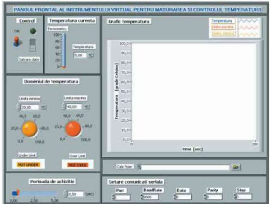
Fig. 3 - Panoul frontal al aplicației pentru monitorizarea și controlul temperaturii într-o încălță
